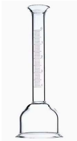
图 1 小号 4mL 分度值 0.1mL 示意图
