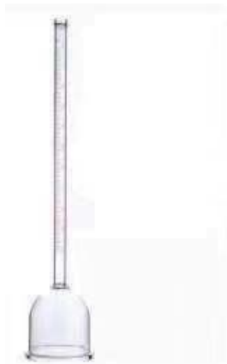
图 4 10mL 分度值 0.1mL 示意图
