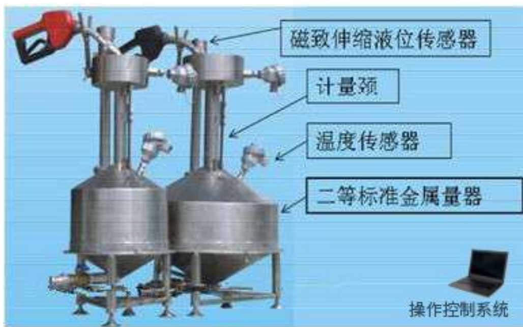
图1 燃油加油机自动检定装置组成示意图
