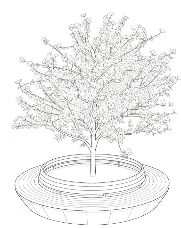
图 C. 7 座椅类防车辆冲撞设施样式二
