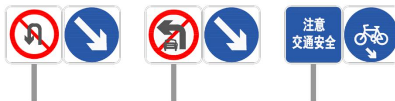
图 166 桩头标志（单柱双面）
