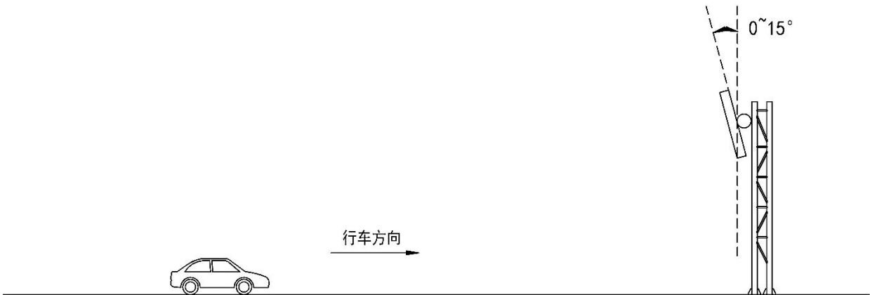
图 3 路上方标志安装角度
