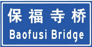
图 126 跨线桥桥名标志示例
