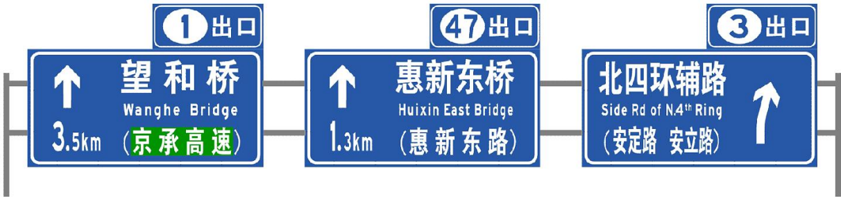
图 129 横向多出口预告标志示例
