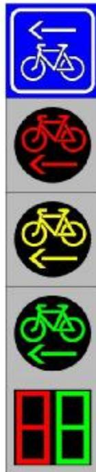
图 45 五联左转非机动车信号灯灯具样式
