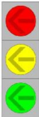
图 49 左转复合圆形机动车信号灯灯具样式
