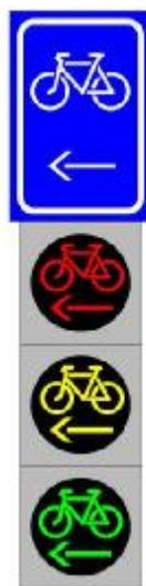
图 46 四联左转非机动车信号灯灯具样式
