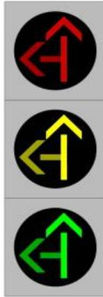
图 48 左转复合直行方向指示信号灯灯具样式
