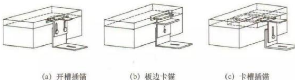
图 6.4.8-1 装饰板锚固形式示意图
