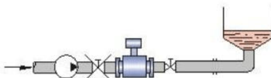
图B.6 电磁流量计与阀门的安装位置示意图
